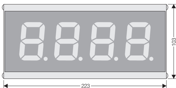
XDM-15 ve skříňce, výška zobrazení 56 mm
