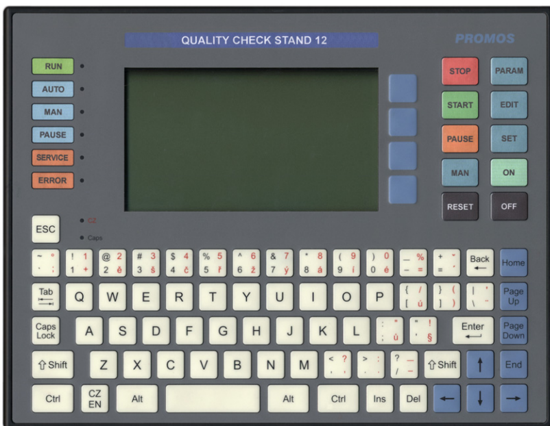
Obr. 1: Pohled na terminál s příkladem popisu uživatelsky definovaných funkčních kláves a indikátorů LED
