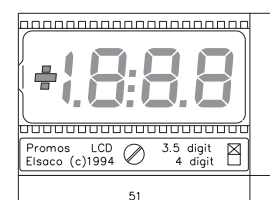
3½ místný displej HLCD-02 výška číslic 13 mm
